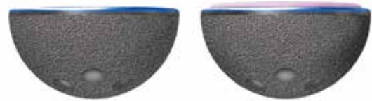
セラミックライナーの正しい設置
